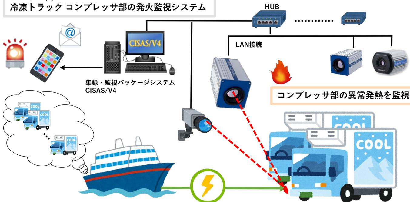
船から冷凍トラックのコンプレッサ部へ電源供給し、冷凍温度を保持
