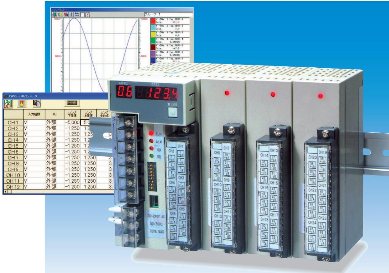
SE3000は、パソコンと接続してデータ集録ができる入力スキャナで、入力点数6点のベースユニットに入力点数6点ごとのサブユニットを最大7台（最大48点）まで増設し、アナログデータを取込むことができます。
