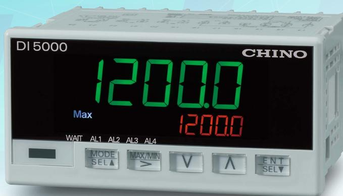
DI5000は、見やすい5桁11セグメント表示を搭載した、測定精度 $\pm 0.1\%$ \*1、サンプリング周期約0.1秒の96×48mmデジタル指示警報計です。熱電対、測温抵抗体、直流電圧・電流のマルチレンジ入力や警報出力などを搭載しています。赤外線通信を利用して盤に取り付けた状態で前面からパラメータ設定が可能です。
